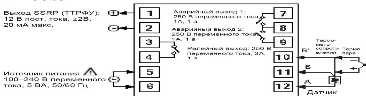
Рис. 9. Электрическая схема температурного контроллера.
